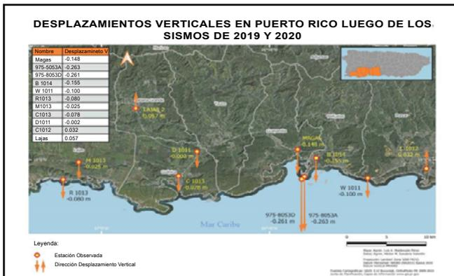
Figura 7: Puntos de control observados y desplazamientos verticales (Fuente: R. Moreno)
