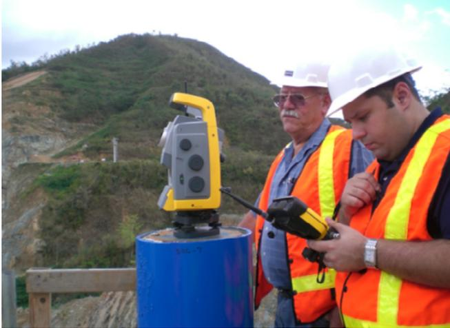
Figura 6: Instalación recomendada de puntos de control (Cortesía del autor)
