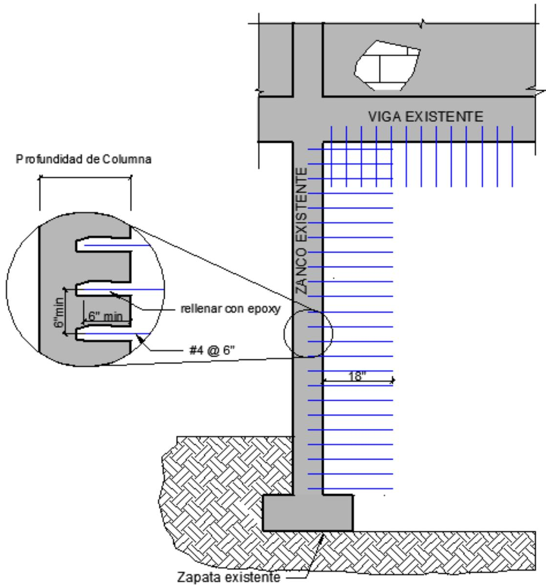
Figura 9. Instalación de Dowels a las Columnas o Zancos Existentes
