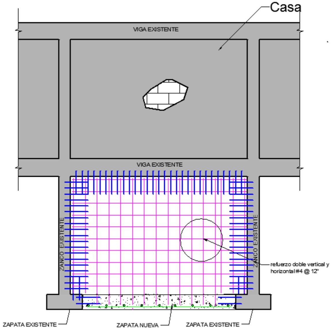
Figura 13. Elevación Parte Posterior Residencia Mostrando el Varillaje
