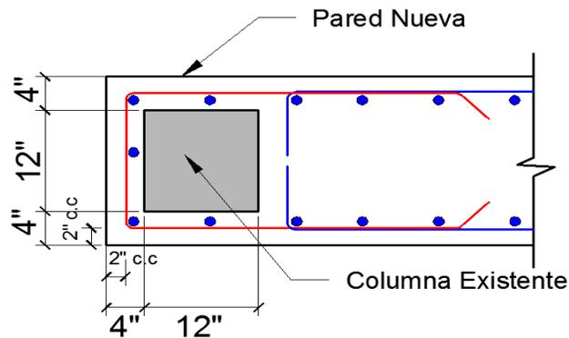
Figura 20. Pared Nueva Abrazando Columna Existente de 12" x 12"
