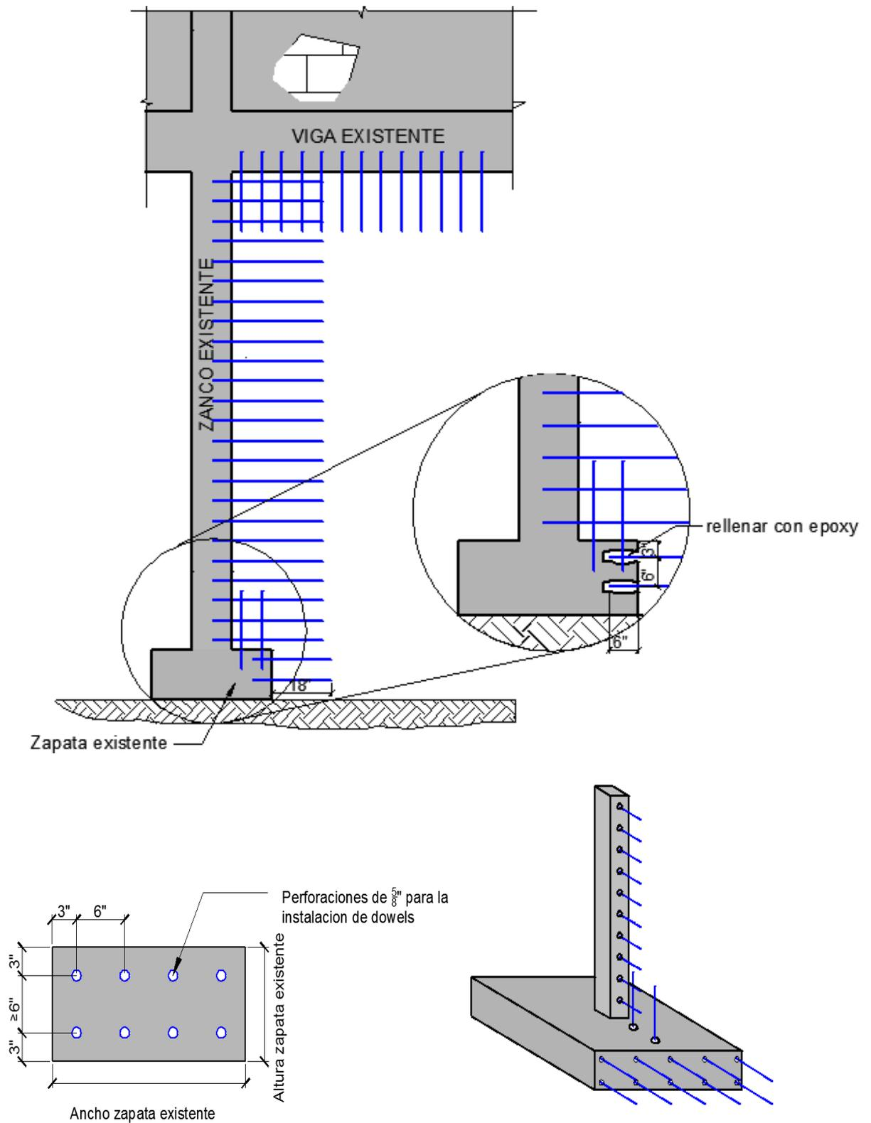
Figura 11. Instalación de Dowels a la Zapata Existente
