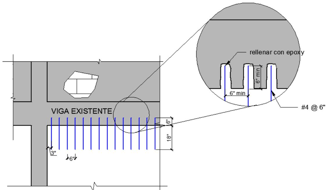
Figura 21. Instalación de Dowels en Viga Existente
