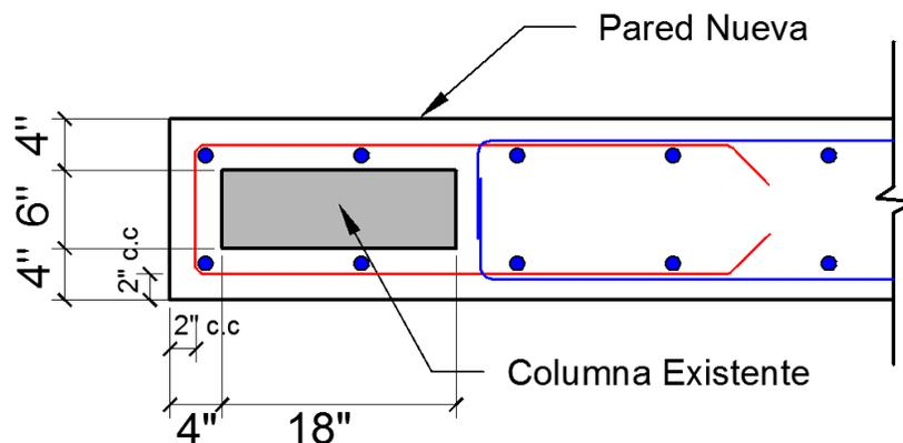
Figura 19. Pared Nueva Abrazando Columna Existente de 18" x 6"
