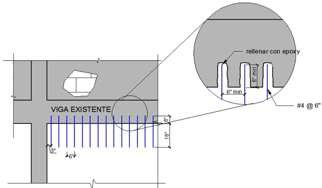
Figura 8. Instalación de Dowels a la Viga Existente
