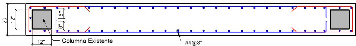
Figura 27. Ejemplo de Pared 20" para Columna de 12" x 12"
