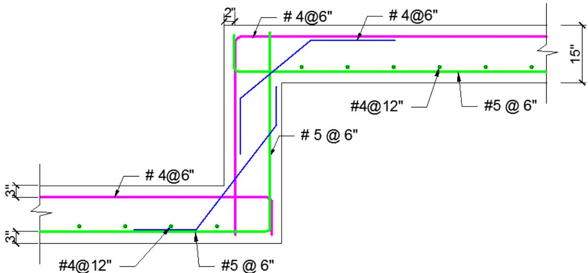
Figura 16. Detalle de la Nueva Zapata Escalonada
