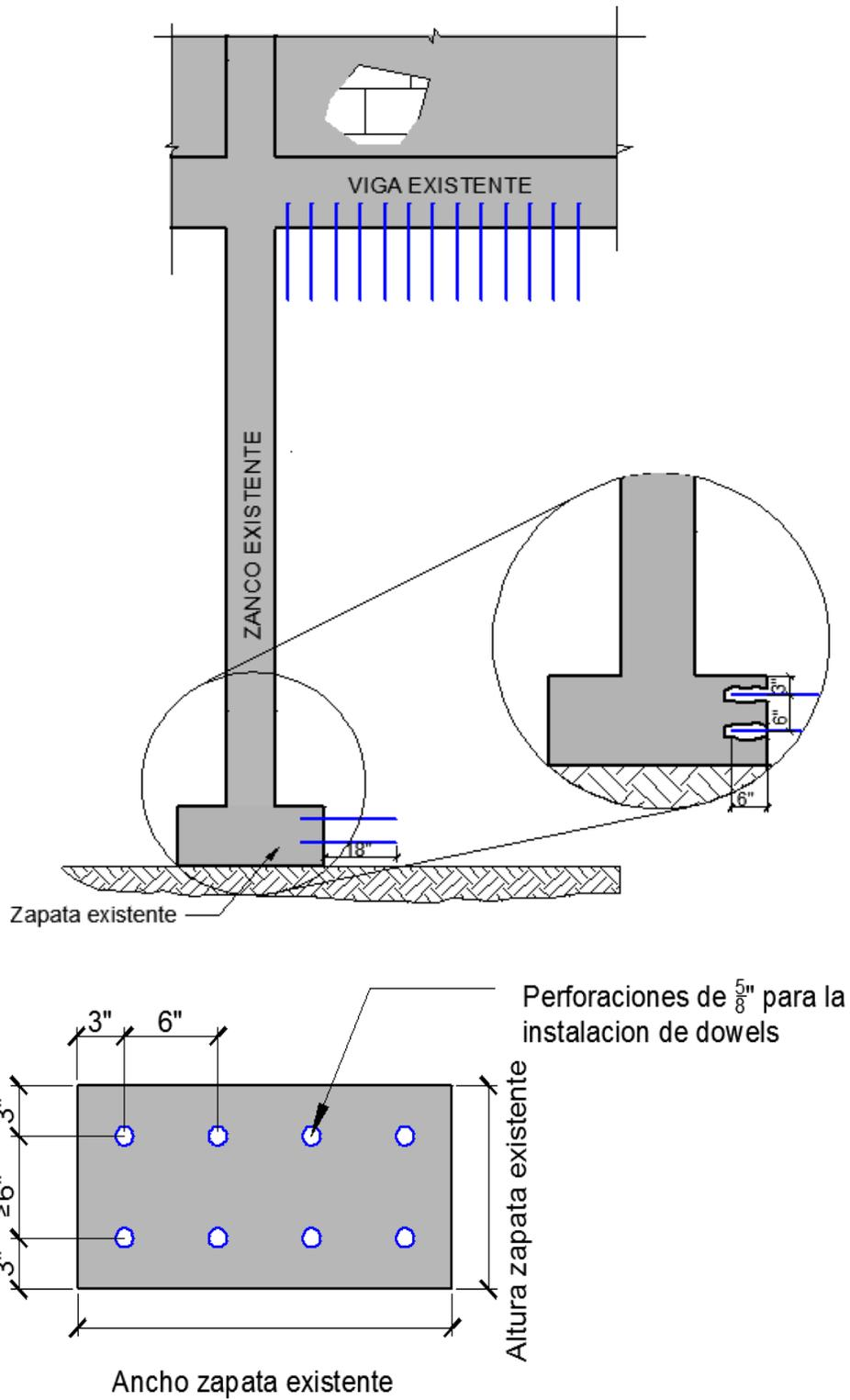
Figura 22. Instalación de Dowels a la Zapata Existente
