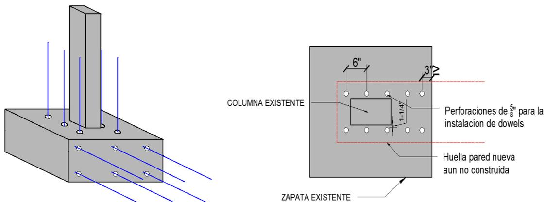
Figura 24. Instalación de Dowels en la Zapata Existente
