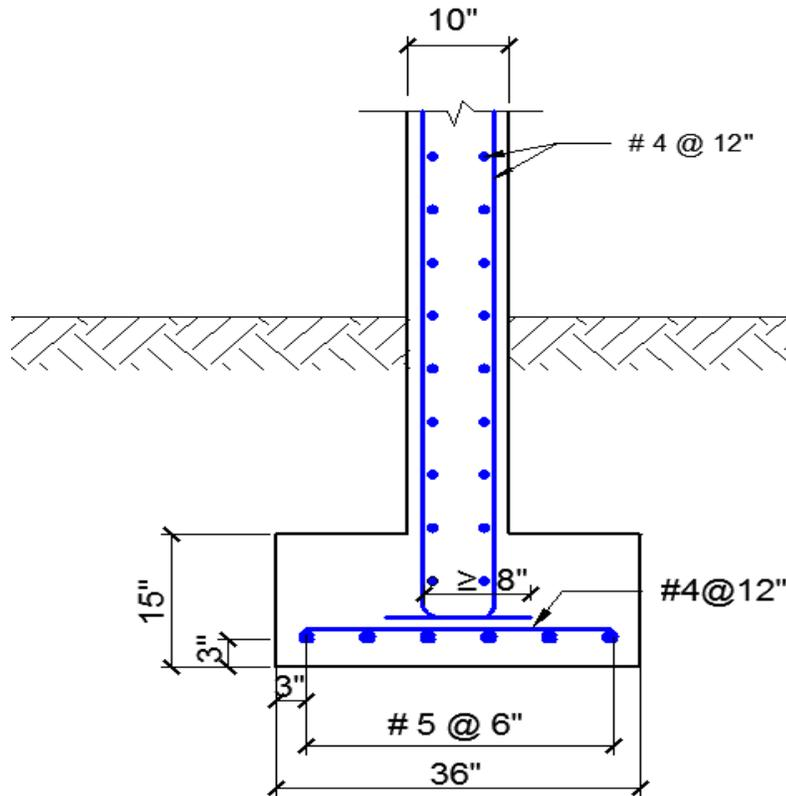
Figura 12. Sección de Zapata Nueva para la Pared
