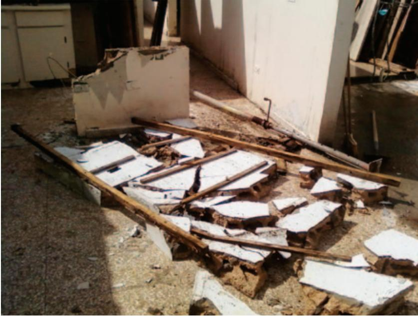
Foto 3. Pared desplomada, simulación experimental de terremoto
