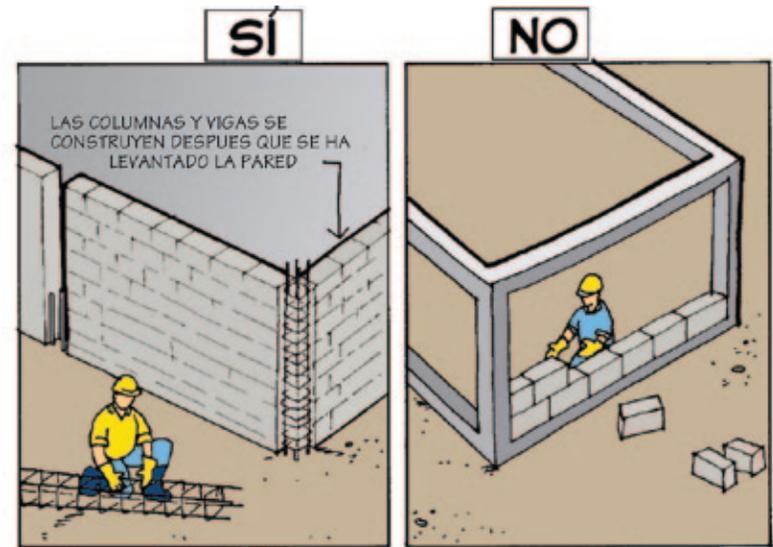
Deben construirse en lo posible amarres y elementos de confinamiento alrededor de todas las paredes y los huecos de la estructura.
