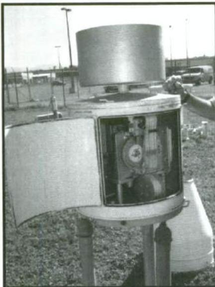
Figuras 30: Diferentes tipos de pluviómetros. Figura 30a: "Weighing-Bucket".
