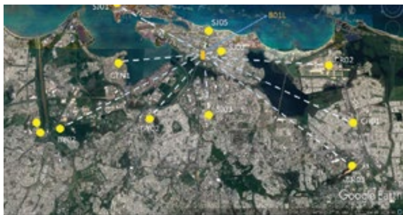
Figura 4. Micro-red en la ZMSJ. Estaciones “disparando” a Minillas que transmite vía satelital al RUM.
